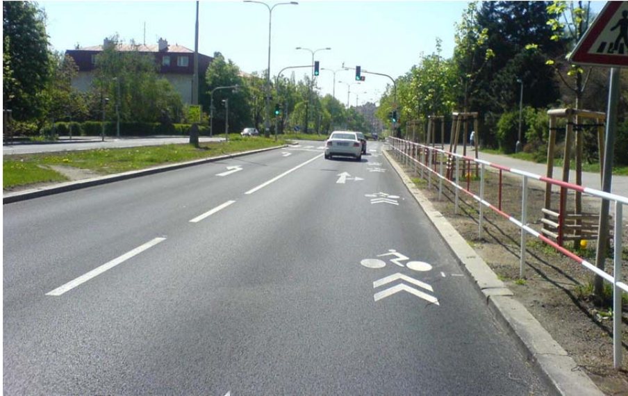
Abbildung 30: Sharrows sind eine Bodenmarkierung zur Lenkung des Radverkehrs, durch die RadfahrerInnen im Straßenraum sichtbar gemacht werden.
